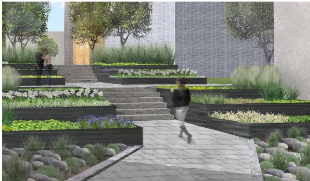
Figur 8. Urban dagvattenhantering med trappade regnträdgårdar. (Lagerkvist & Bååth, 2016)
