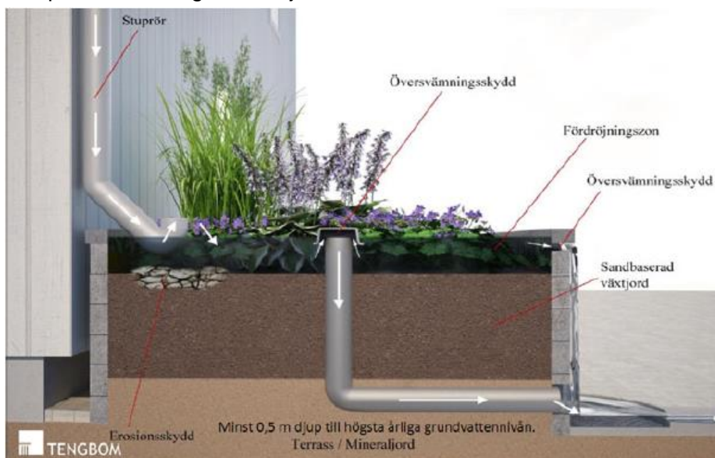
Figur 7. En växtbädd med fördröjnings- och översvänningszon för infiltrering och behandling av dagvatten. (Tengbom arkitektkontor, 2014)
